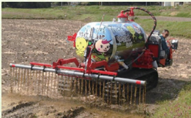
バイオ液肥の散布作業
