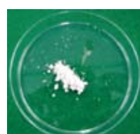
Fig.4 約 900℃焼成後の粉碎物 焼成によって有機成分の分解・離脱がおきて純度の高い CaO となる
