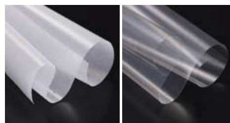
Fig.6 インフレーションフィルムの試作例 右の純粋 PLA フィルムに比べて左の貝殻混合試作フィルムは半透明になった
